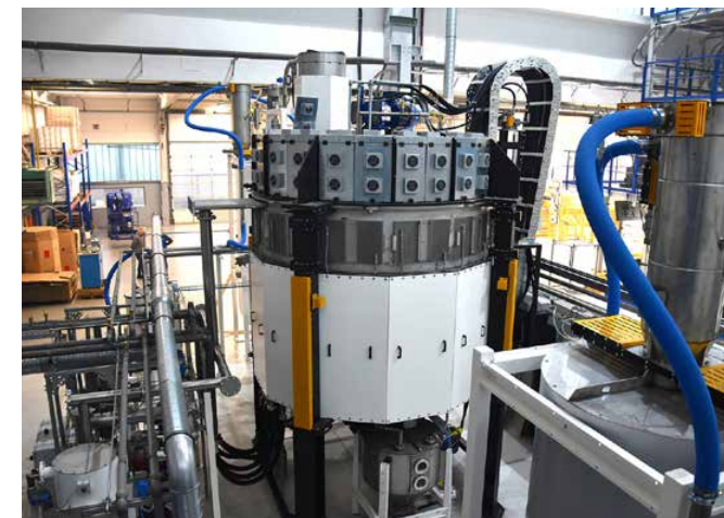
IV-Booster zur Tray-Flake-Aufbereitung
